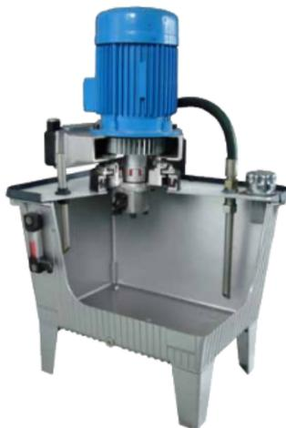
Controle de nível, temperatura, impurezas, sucção e recalque.
