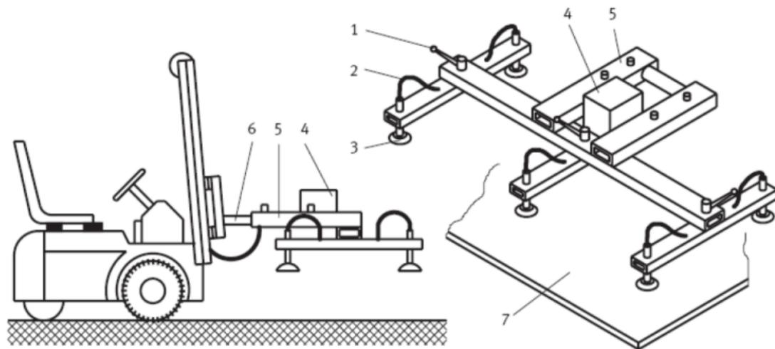
Um sistema de vácuo é utilizado para a manipulação de placas de aço através de um dispositivo preso à empilhadeira. O vácuo é ligado e desligado através de um botão-trava.
