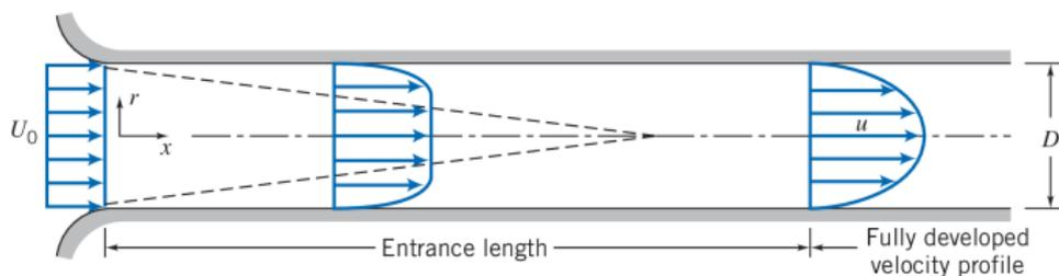
Devido a condição de não-deslizamento na parede de tubo, o escoamento laminar de entrada altera seu perfil decorrente a camada limite formada ao longo da parede e condição de velocidade nula. Ressalta-se ainda que, na condição de desenvolvimento completo considera-se perfil de escoamento viscoso em todo o diâmetro de tubo.
