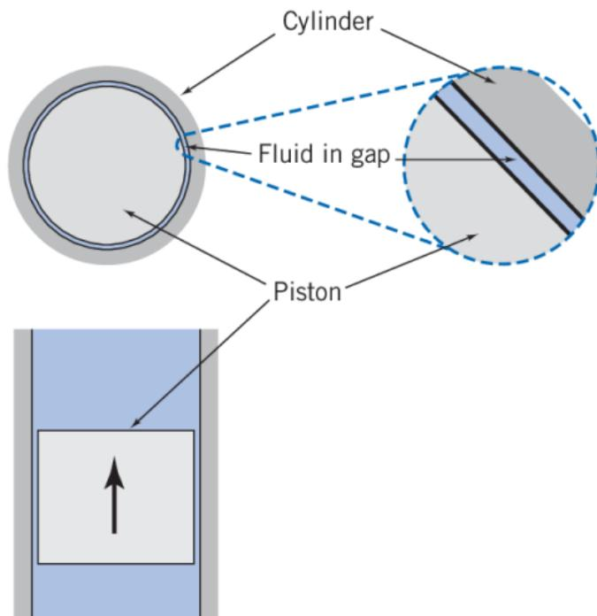
Sabe-se que frequentemente há vazamentos através da folga anular entre um pistão e um cilindro.
