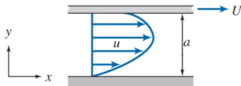
Perfil de velocidade adimensional para esc. laminar C.D entre placas paralelas infinitas com placa superior movendo-se com vel. constante  $U$
