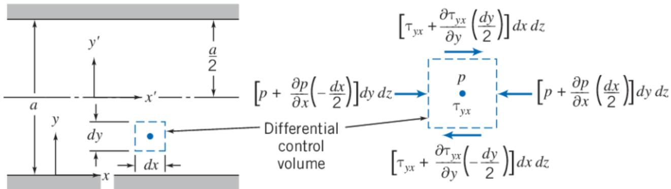
Condição de contorno de não-deslizamento impõe que: Em  $y = 0$ ,  $u = 0$ , e em  $y = a$ ,  $u = 0$ .
